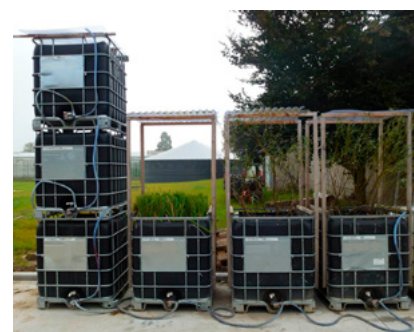
Biofiltre avec unités filtrantes et plantées
