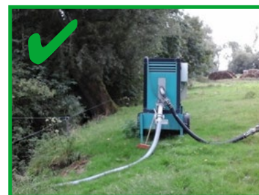
L'eau peut être pompée à partir du cours d'eau grâce à une pompe dissociée du pulvérisateur, en vue de remplir une citerne. Des autorisations peuvent être requises (voir Contrats de rivière).
