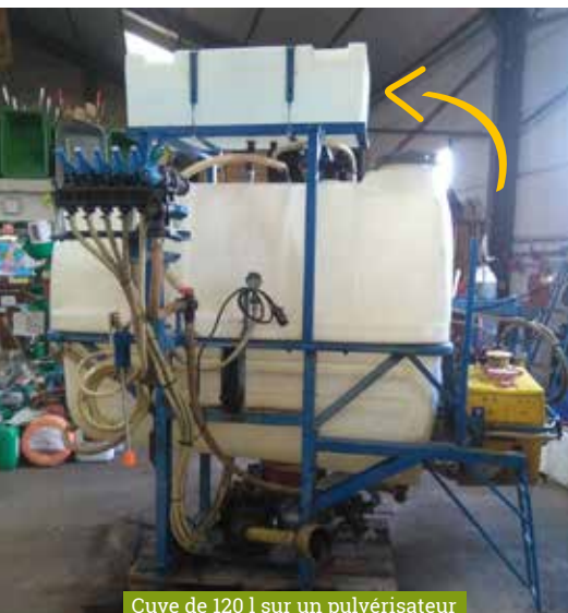
Cuve de 120 l sur un pulvérisateur porté Allaeys, 1997, 1 1000 l.
