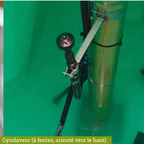
Gyrolaveur (à fentes, orienté vers le haut) sur pulvérisateur trainé Berthoud, 2018, 3200 l.
