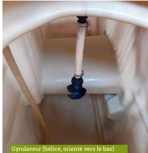
Gyrolaveur (hélice, orienté vers le bas) sur pulvérisateur porté Platz Holder, 1998, 1000 l.
