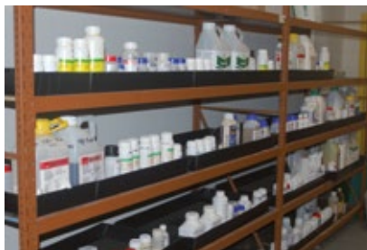
Les produits sont placés dans des bacs de rétention
