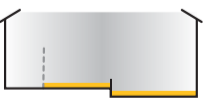
Bereich mit Stroheinstreu und Gang mit Stroheinstreu mit Stufe und Mäuerchen, ohne Schiebereinsatz (selbstreinigender Steig) oder mit Schiebereinsatz (M)
