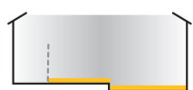
Bereich mit Stroheinstreu und Gang mit Schiebereinsatz, mit Stufe, ohne Mäuerchen (O)
